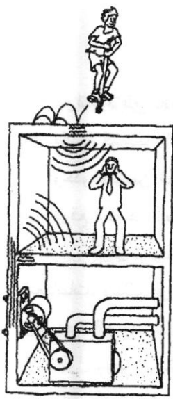
شكل ١-١ انتقال اهتزازات الصوت الى الفضاءات المجاورة
